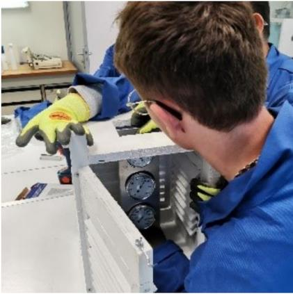
Fabrication d'un abri de station météo
